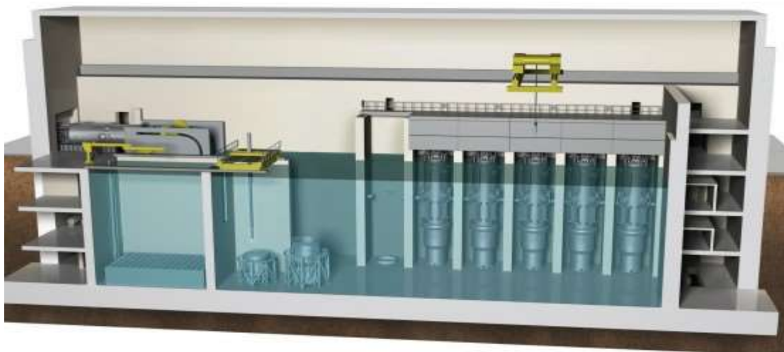
Querschnitt eines Reaktor Gebäudes, wie es die US-amerikanische Firma NuScale Power entworfen hat (NuScale Power, LLC.)
